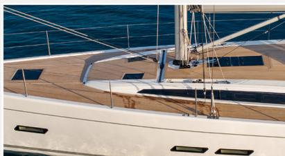
Le classiche rotaie longitudinali per regolazione delle vele dal pozzetto, sono incassate nella tuga per mantenere sgombro il passaggio laterale ed avere un corretto angolo di scotta.
